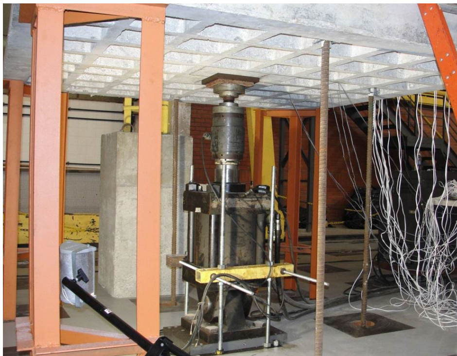
Figura 2.13 – Sistema de aplicação de carga (SOUZA et al., 2015)
