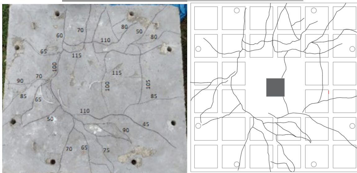
Figura 4.21 – Padrão de fissuração da laje L1.
